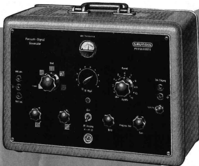
Service-Gerät zur Prüfung von Fernsehempfängern (europäische Norm 625 Zeilen). Bild und Ton für 10 Fernsehkanäle mittels Kanalwähler einstellbar. Überwachung des Bild-Tonträgerabstandes durch Diskriminator und Meßinstrument. - Ferner zu entnehmen: 2 UKW-Frequenzen und 5,5 MHz Ton ZF (FM modulierbar). - HF-Ausgang: 60  $\Omega$  Koaxial-Buchse 3,5/9,5. - Modulation, Bild: mit eingebautem Bildmustergeber für veränderbare waagrechte und senkrechte Balken, Gitter- und Schachbrettmuster.
